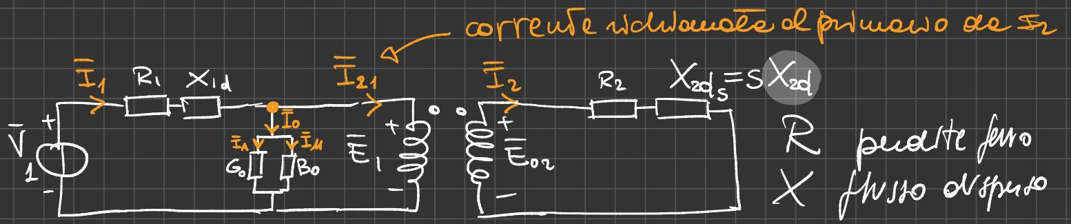
$$\bar{E}_2 = \bar{E}_{20} S \quad (\text{relazione tra situazione con rotore fermo e con scorrimento})$$
