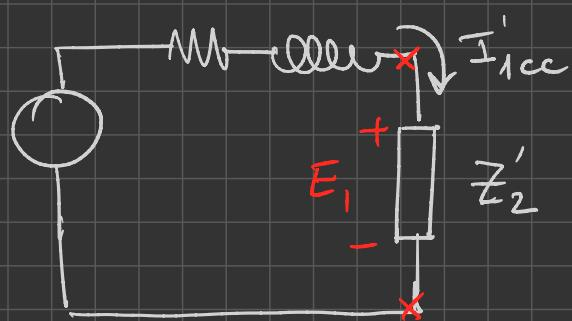
possiamo semplificare il circuito equivalente considerando le resistenze equivalenti visto da  $\bar{E}_1$
